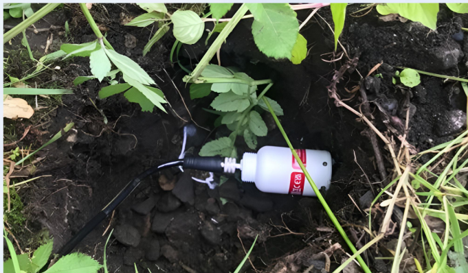
図1:ネットワークレールのインフラ設備沿いに設置されたDelta-T社製SM150T土壌水分センサー。浸水しやすい場所に深さ30cmで水平に設置され、土壌水分の変化を監視しています。
