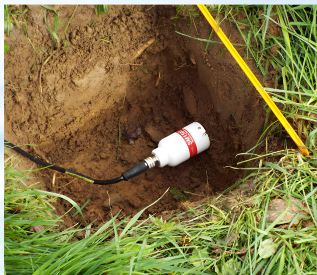
図3. SM150T土壌水分センサー。パークグラス実験場において深さ20cmに設置
