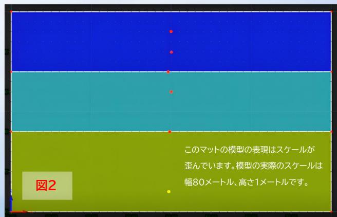
赤と黄色の点は、さまざまな材料プロファイルを背景に、設置されたPR2プロファイルプローブの6つの測定ポイントの深さを表しています。
