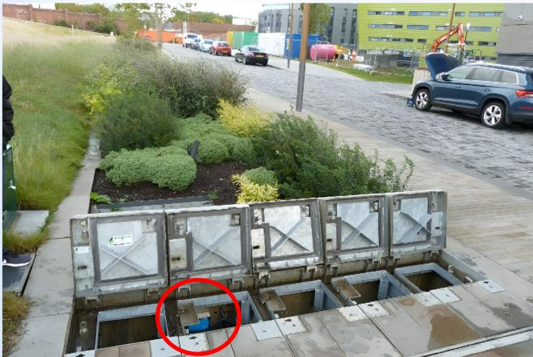
左の画像は、道路沿いの流出水モニタリング設備に設置されたGP2です。
