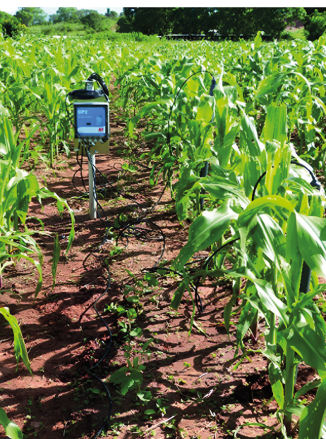
図1 ルサカのリエンペ農場の トウモロコシ・大豆畑に設置 されたケーブル付きデータロガー
