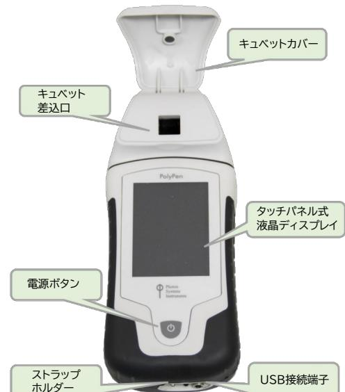
PolyPen-Aqua PA210は、懸濁液の分光測定を目的としたキセノン白熱ランプ、GPS内蔵の携帯型測定器です。
