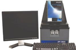
最新のISO24443要件を満たす完全な統合ターンキーシステムとして利用可能な紫外線透過率分析装置です。
