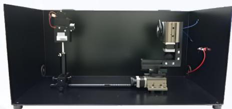
点光源条件下で単一LEDの角度強度分布を測定するために設計されたLEDゴニオメーターは、検出器から500mmの距離に設置された2軸ゴニオメーターを備えています。ゴニオメーター上のLEDは自動的に回転するため、追加の面の測定も可能です。
