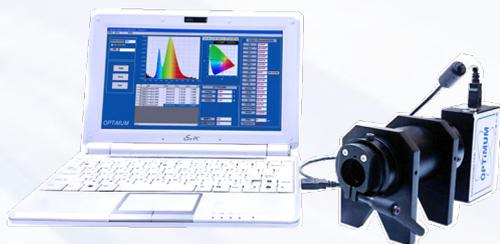
CIE127では、近接場測定の詳細条件としてAとBの2つが定められています。この場合、LEDは100mm<sup>2</sup>の面積を持つ検出器から正確な距離(条件A:316mm、条件B:100mm)に配置されます。
