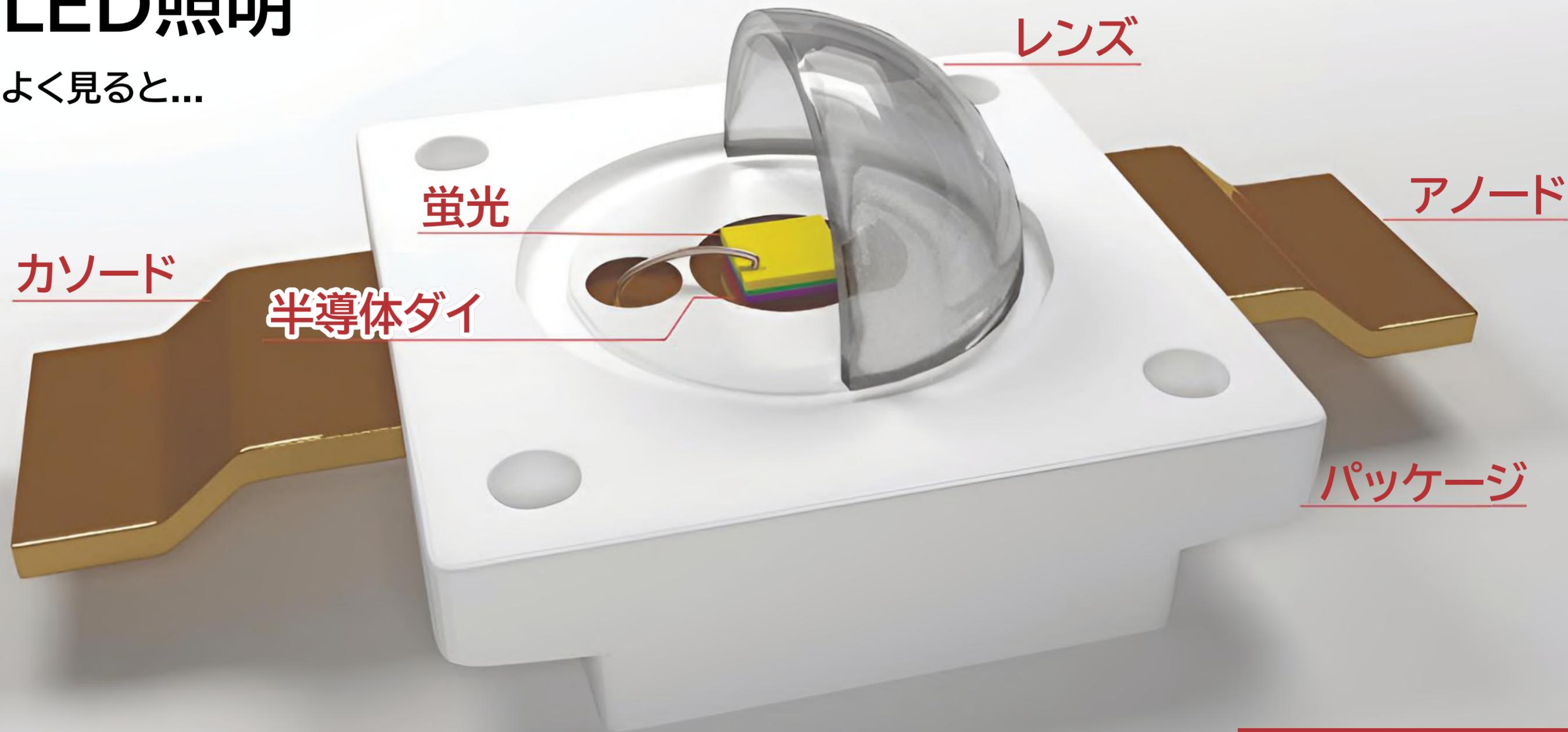
LEDライトは、電気が半導体ダイを介して実行されると機能し、青みがかった光を生成します。半導体上の黄色の層に注意してください - 半導体の青みがかった光を変化させて快適な白色光になります。この黄色の層は、蛍光層または蛍光体層と呼ばれます。
