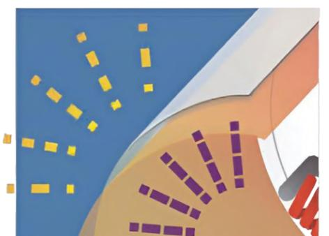
4. 紫外線が蛍光体でコーティングされた管の内面に当たり、蛍光体が発光します。つまり、光(紫外線)を使って可視光線を作り出すのです。
