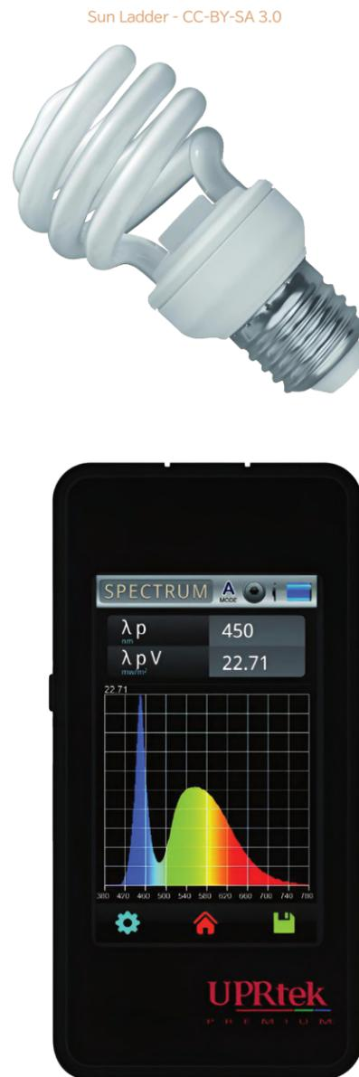
uSpectrum画面で「ピーク表示」をオンにしてください<sub>4</sub>。キャプチャ後、左上隅に半帯域幅が表示されます<sub>5</sub>。スパンの12nmセクション内の詳細は平滑化(平均化)されます。
