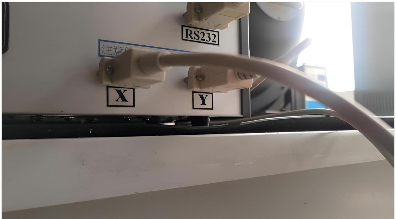
XケーブルとYケーブルにはすでにラベルが付いています。対応するメカニズムポートに差し込み、締めるだけです。残りのRS232ケーブルは、コントローラーの最後の空きポートに接続します。RS232ケーブルのもう一方の端は、アダプターが取り付けられたコンピューターのUSBポートに接続します。必要なドライバーはUSBドライブに含まれています。
