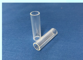
ホウケイ酸ガラス製反応容器
