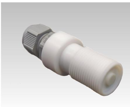
PWA254殺菌ランプモニターは、空気または高圧水消毒タンク(リアクター)内のUVCランプからのUV出力を継続的に監視するように特別に設計されており、データ取得システムと併用すると、ランプの経年劣化に伴う有効性を示すことができます。このセンサーは、253.7nmの水銀ランプの殺菌UVC波長に敏感です。優れたコサイン性能、20mm 1.5mmピッチの外部スレッド、およびユーザーインターフェイスへの簡単な接続が可能なMolex<sup>®</sup>スタイルのコネクターを備えています。センサーは、0~5Vの線形アナログ電圧出力信号を持ち、公称スケーリング範囲は1V~100  $\mu\text{W}/\text{cm}^2$  です。回路は、9Vバッテリー、または8~24VDCの範囲のその他のDC電圧源で電源を供給できます。UV水および空気消毒システムの有効性は、殺菌ランプの有効性によって決まります。時間が経つと、最高のUV水処理システムでも、水の殺菌能力は著しく低下します。殺菌ランプの出力は、ランプが古くなったり、使用により汚れたりすると低下します。
