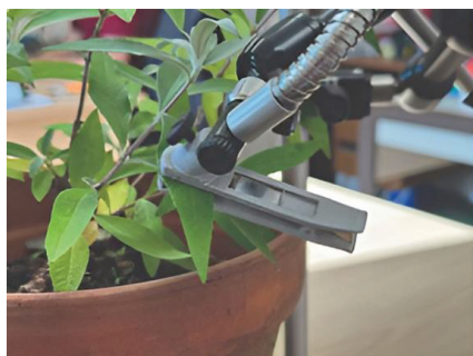
図6. サポートアームは広範囲に可動するため、さまざまな種類のサンプルを測定する際に光ファイバーを便利かつ安全に配置できます。
