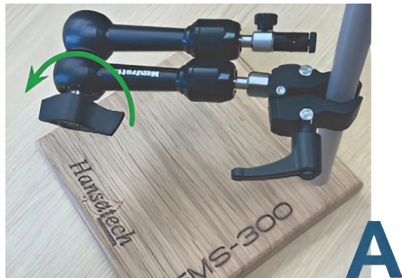
図6. サポートアームは広範囲に可動するため、さまざまな種類のサンプルを測定する際に光ファイバーを便利かつ安全に配置できます。
