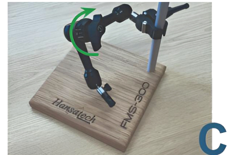
図6. サポートアームは広範囲に可動するため、さまざまな種類のサンプルを測定する際に光ファイバーを便利かつ安全に配置できます。
