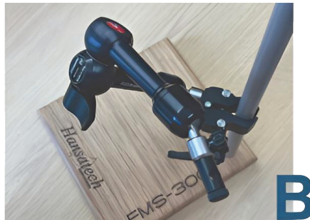
図6. サポートアームは広範囲に可動するため、さまざまな種類のサンプルを測定する際に光ファイバーを便利かつ安全に配置できます。
