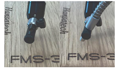
図5. 光ファイバーケーブルは、サポートアームの端にあるアダプターによってしっかりと固定されます。
