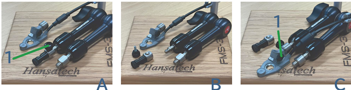
図9. 保持つまみネジを外して光ファイバーアダプターを取り外します。 アダプターをPTL-100に交換し、つまみネジを取り付け直して PTL-100を所定の位置に固定します。
