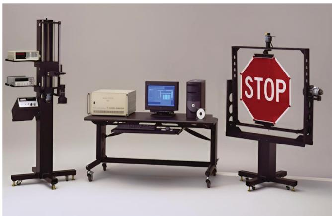
RoadVista Model 940D ゴニオメーターシステムは、再帰性反射材、デバイス、自動車の照明、光源の測光テストが行える究極のシステムです。
