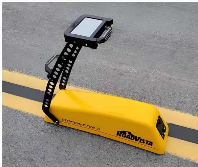
StripeMaster 3 再帰性反射測定器は、オールインワンの舗装標示資産管理システムで、道路、高速道路、飛行場の安全性を高めるために、機関や請負業者が舗装標示を迅速かつ確実に把握できるようにします。現場で実証された使いやすい機能により、道路標示の反射と視認性を迅速に測定して、オペレーターの安全性が向上します。
