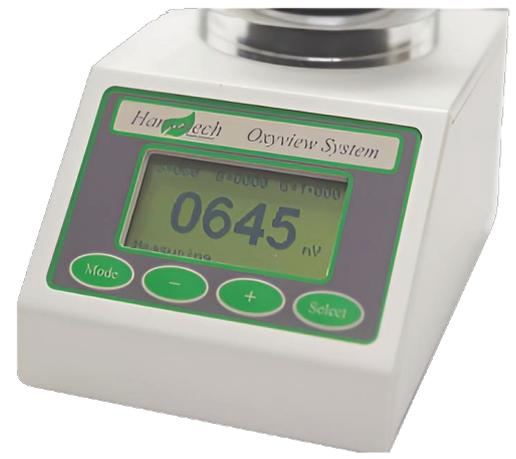
Oxyviewは、4つのタッチセンサー式ボタンを備えたコントロールパネルを介して設定および制御されます。設定は、メニュー画面の表示ガイドラインの通り、各ステップに従うことで用意に実行できます。これらの設定手順には、スターラー速度の設定(液相測定用)およびバックオフとゲインの設定が含まれます。設定が完了すると、Oxyviewコントロールユニットは、サンプルの酸素含有量の読み取りを開始します。
