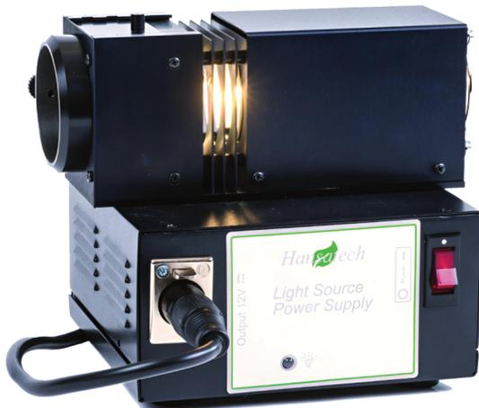
LS2 光源には、冷却ファン、赤外線低減「ホットミラー」、および光学系が組み込まれており、ビーム全体の強度のばらつきが少なく、平行光に近い光を提供します。50mm 角の光学フィルターまたは手動シャッタープレートを取り付けるために 2 つのスロットが用意されています。
