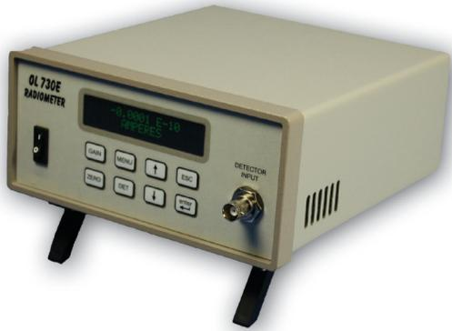
OL730Eはプリアンプが内蔵されており、 $1 \times 10^{-14}$ アンペアの感度を持っています。適切な検出器、光学フィルター、入力光学系を組み合わせれば、研究レベルの精度と正確さを持つ放射計/光度計システムとして使用することができます。オプションとして、シリコン、光電子増倍管、ゲルマニウム、インジウムガリウム砒素などの検出器が用意されています。
