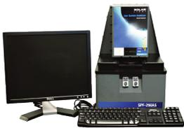
**紫外線透過率分析装置**は、最新のISO24443要件を満たす完全な統合ターンキーシステムとして利用可能です。
