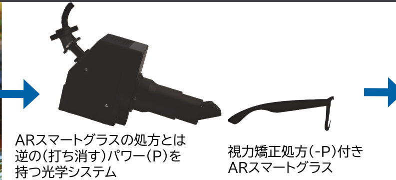
視力補正ARの主なシースルー試験要件例
