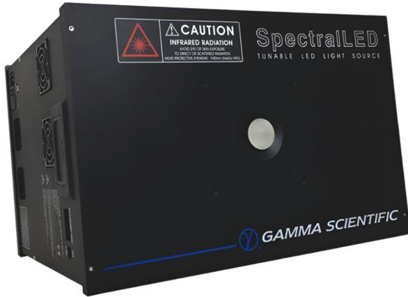
SpectralLED® RS-7-940は、最高の解像度と精度を実現するために、中心波長940nmを持つ16個のディスクリットLEDデバイスを内蔵しています。直径38mmの均質化されたロッド(長さ190mm)から直接出力され、ディフューザーは出力面に外付けされています。
