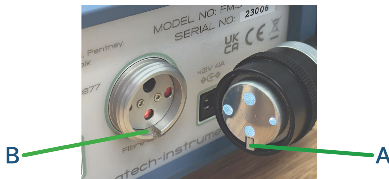
図3. FMS-300コントロール ユニットの背面パネルの光ファイバーケーブルを接続。 光ファイバーケーブルのタブ(A)は、光ファイバーソケット(B)のキー溝に合わせます。
