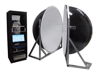
LED/照明器具の全光束測定システムは、Gamma Scientificの 従来のRadOMA GS-1220分光放射計プラットフォームと 3ポート、直径2メートルの積分球を組み合わせています。 このシステムには、Light Touch LEDソフトウェア、Light Touch コントローラー、および2mの柔軟な光ファイバーが含まれています。 品質管理および高速LEDテストのアプリケーション向けに最適化 されており、積分時間の範囲は2 マイクロ秒から3秒です。特定の LEDタイプ用のさまざまなテストソケットも利用できます。
