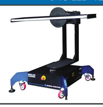
940 LED-1200 ゴニオメータは、さまざまなサンプルサイズを測定するために最適化されたモデルを備え、大型LED照明器具、ランプ、モジュールの角度依存の空間放射特性を正確に測定できるように最適化されています。940 LED-1200は、最大直径1250mm、重量30kgまでのサンプルを測定可能で、CIE、DIN、IES規格に準拠しています。
