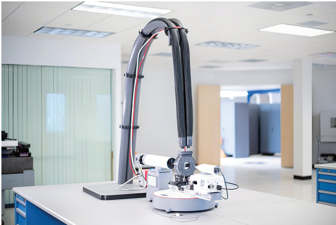
サーマルチャンバーとスカイフックを備えた LensCheck VIS (温度コントローラーとマニホールドは写っていません)
