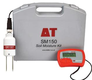
このキットは、SM150T土壌水分センサー、専用読み出しメーター、キャリアケースで構成されています。ケーブルとコネクタは、強力な湿潤環境に不可欠な防水仕様です。
