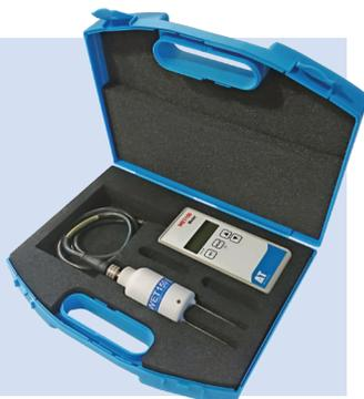
\*WET150をポータブルセンサーとして使用する場合は、気温が土壌/基質温度と大きく異なるない、十分に平衡化された環境でのみ使用することを推奨します。
