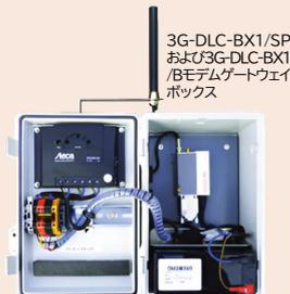
どちらのシステムにも、筐体、バッテリー、クワッドバンドモデム、スマートSIM、バッテリー、ケーブル、アンテナ、マストに固定するためのマウントキットが含まれています。さらに、3G-DLC-BX1/SPバージョンには、30Wソーラーパネルが含まれています。ロガー(別売)はモデムボックスの外側に取り付ける必要がありますのでご注意ください。システムを完成させるには、データパッケージも必要です。
