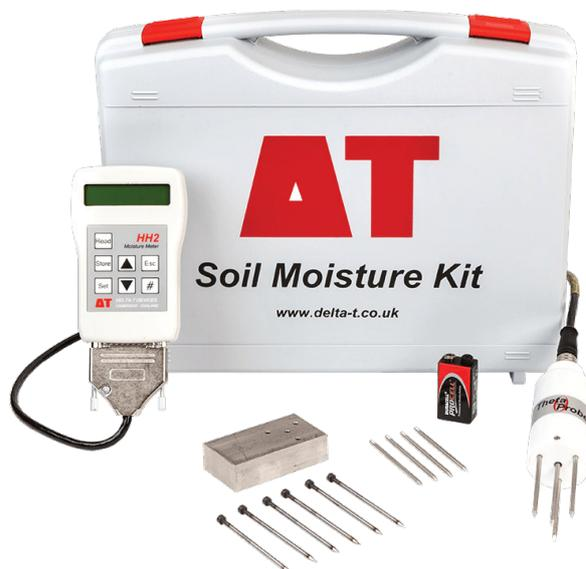
シータキットの使い方は簡単です。接続したHH2水分計のスイッチを入れ、プローブピンを土に完全に差し込み、HH2の読み取りボタンを押すだけで、水分測定値\*が表示されます。測定値は、ボタンを1回押すだけで保存でき(必要な場合)、後でPCにダウンロードできます。キットは、ML3シータプローブ土壌水分センサー、HH2水分計(読み取りユニット)、交換用センサーロッド、キャリアケースで構成されています。ご注文については7ページをご参照ください。
