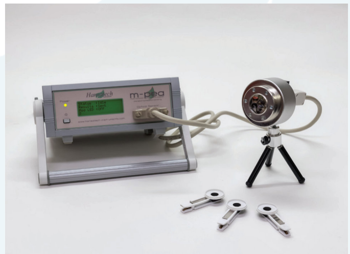
図3. M-PEA(多機能Plant Efficiency アナライザー)クロロフィル蛍光光度計
