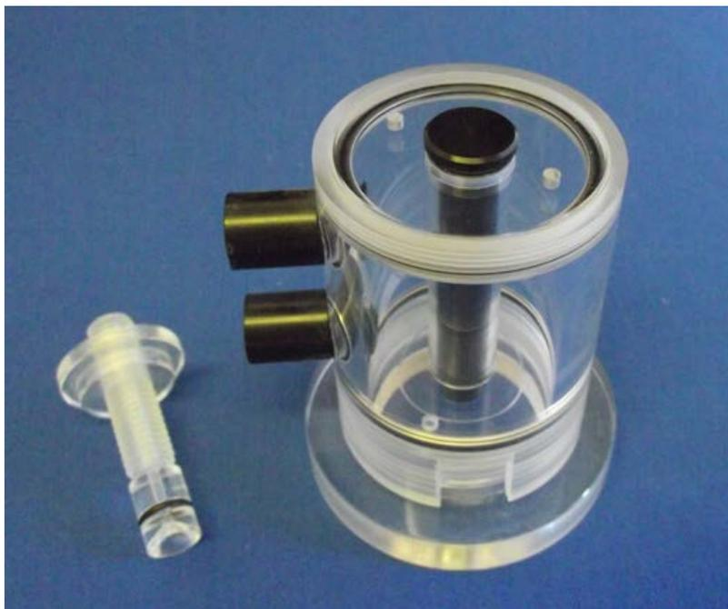
トッププレートキーは、下側に2本の金属ピンがあり、電極チャンバーのトッププレートにある2つの窪みに合わせます。キーは、アライメントツールの真上にあるため、トッププレートを反時計回りにゆっくりと緩めることができます。
