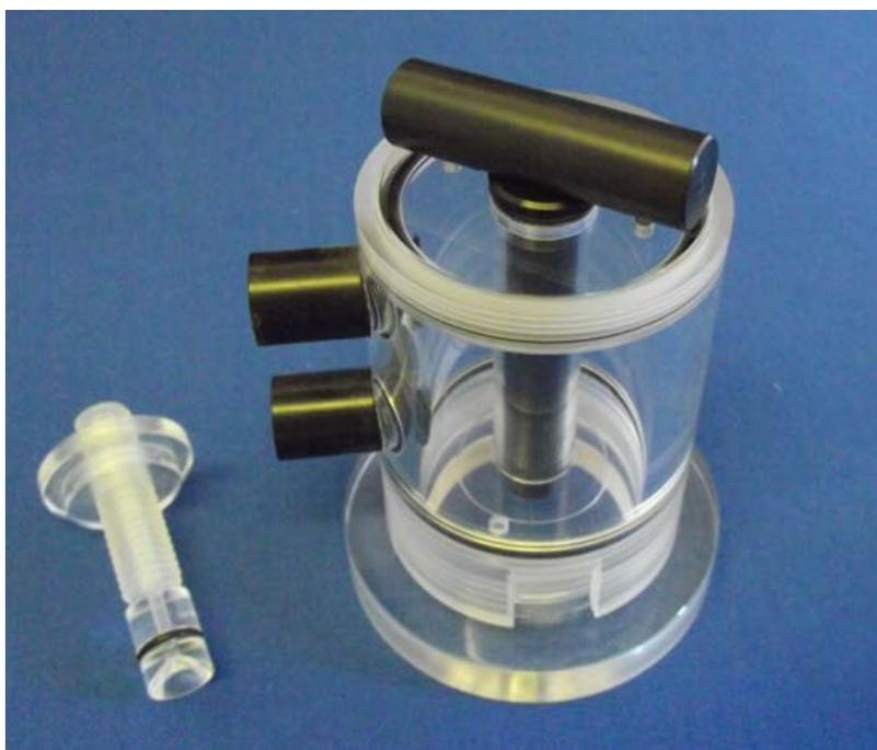
トッププレートのネジが完全に外れたら、ガラス製反応容器とともに電極チャンバー本体から持ち上げることができます。アライメント治具から反応容器を注意深く取り外します。トッププレート上の小さなOリングを取り外します。また、電極チャンバーの底板にはもう一つOリングがあります。
