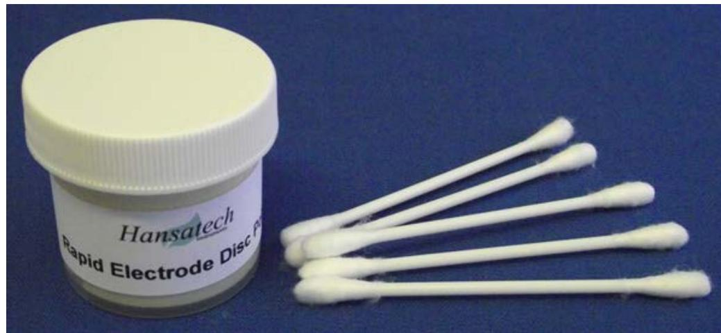
このキットがない場合、ユーザーは市販の金属磨き剤や様々な研磨剤化合物で電極を洗浄しています。電極に不可逆的な損傷を引き起こす可能性があるため、不適切な材料の使用には注意が必要です。いくつかの金属磨き剤は、アンモニア塩基または溶剤添加剤を含みますのでディスクに有害です。これらの物質は、白金陰極に不可逆的な損傷を引き起こし、エポキシ樹脂に著しい損傷を引き起こす可能性があります。研磨物質による過度のクリーニングは、電極ドームの形状をひどく傷つけたり変形させたりと、陰極を横切る電解液の層の不均一を引き起こし、酸素信号の不安定性、ドリフトおよび応答性の欠如を招く可能性があります。S16電極クリーニングキットは、OxygraphおよびOxytherm Systemsすべてに付属しており、ハンザテック社日本総代理店旭光通商にて販売しています。クリーニング手順の詳細は、[クリーニング手順](#)のセクションに記載されています。
