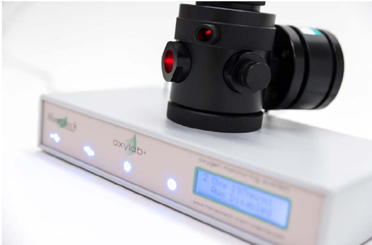
Oxylab+酸素電極コントロールユニットは、ミトコンドリアや細胞呼吸の研究から、光合成研究における単離葉緑体懸濁液や固体葉サンプルの測定まで、幅広いアプリケーションにおいて酸素消費及び酸素発生測定をPCで制御できるように設計されています。ユーザーフレンドリーな OxyTrace+データ収集およびシステム構成ソフトウェアとともに、Oxylab+コントロールユニットは、S1クラーク型酸素電極ディスクを各種液相および気相電極チャンバーのいずれかに取り付けて酸素信号を測定するための効果的なツールで、システムのキャリブレーションと構成を迅速かつ簡単に行うことが可能です。オプションの補助入力信号(例:温度、pH、クロロフィル蛍光、TPP+または他の特定のイオン電極など)は、適切な装置を使用することで同時記録も可能です。
