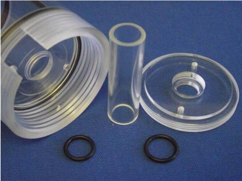
チャンバーを完全に組み立てる際に反応容器の位置がずれていると、プランジャーアセンブリがチャンバーに収まらなくなり、最悪の場合、トッププレート締め付ける際に反応容器に亀裂が入る可能性があります。したがって、電極チャンバーの再組み立ての際には、アライメント治具を使用して反応容器、Oリング、トッププレートおよびボトムプレートを正しくアライメントすることが重要です。
