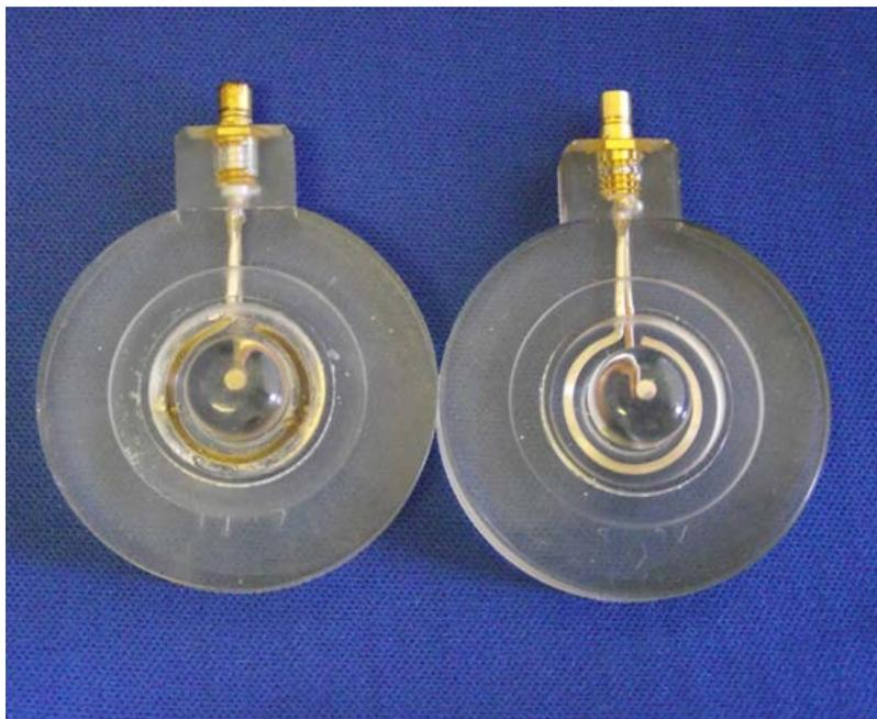
下の画像は、メンテナンス不良の典型的なケースを示しています。ディスクは使用後に掃除されておらず、乾燥剤を入れた密封容器に保管し強い日射を避けることをしていません。結果として、エポキシ樹脂は強い太陽光と環境からの水分の吸収との組み合わせにより変色しています。銀陽極は、ほぼ完全に黒色酸化銀の堆積物で覆われています。プラチナスタッドとドームは汚れて、ひどく傷ついています。これは測定中に膜の下に不均一な電解質層を生じさせ、不安定で応答しない信号をもたらします。このディスクは修理の範疇を超えています。
