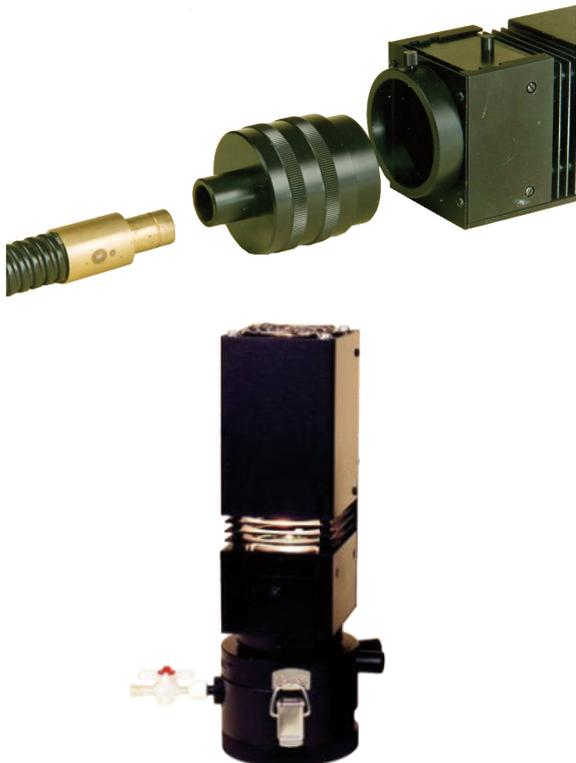
LS2/FO アダプターにはレンズが取り付けられており、ビームを A8 光ファイバーケーブルの端に集光します。これにより、光ファイバーケーブルのチャンバー端での光強度は最大 $8000 \mu\text{mols m}^{-2} \text{s}^{-1}$ まで増加します。
