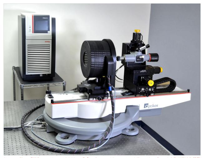
OpTest®レンズ測定システムLP-1000レンズプラットフォームにTM-1150サーマルモジュールを取り付けた状態
