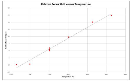
温度に対する一般的な測定値の例 - 画質(MTF)とフランジ焦点距離の変化
