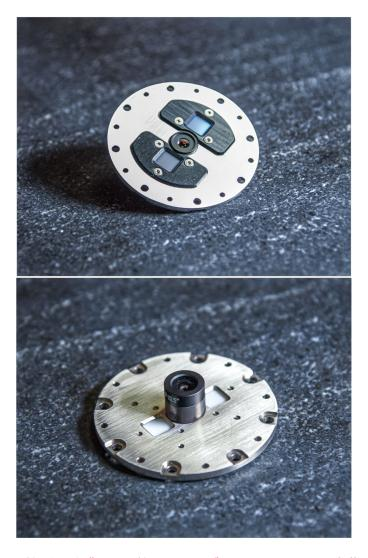
TM-1050 レンズ装着治具に取り付けられた背面照明付きクロームガラスレチクルにより、自動FFL変動測定が可能になります。
