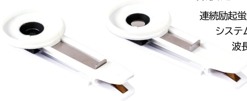
連続励起蛍光システムは、2つの機能を持つ適切なリーフクリップシステムを使用します。まず、リーフクリップは、蛍光と同じ波長域(赤色/赤外光)である環境光から蛍光検出器を保護します。次に、リーフクリップは、測定前に試料の一部を暗順応させます。
