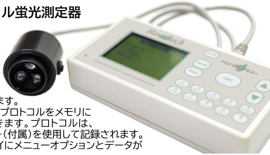
設定や操作が簡単で、基本的な測定機能は Handy PEA+本体で直接設定することができます。より複雑な実験計画は、最大5つのユーザー設定プロトコルをメモリに保存できる機能を使用して実行することができます。プロトコルは、Windows®ソフトウェアパッケージであるPEA+(付属)を使用して記録されます。キーパッドで選択と入力ができ、液晶ディスプレイにメニューオプションとデータが表示されます。
