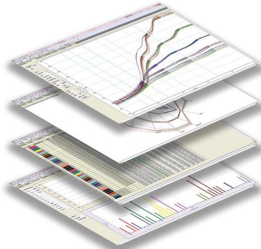
データは、グラフ、表、放射状プロットで表示され、Pocket PEAで測定された58のパラメータの任意の数を表示するようにすべて調整することができます。
