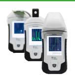
PolyPen-Aqua PA210は、懸濁液の分光測定を目的とした液相サンプル用携帯型反射率測定器 です。バイオテクノロジー、湖沼学、生態学、分子生物学、化学、法医学など、幅広い用途で使用されて います。この装置は、実験室での作業にも、また、内蔵のGPSを使用した屋外での作業にも便利です。 キセノン光源を内蔵したシングルビーム方式による吸光度・透過率の測定が可能で、測定波長範囲は 380~790 nmと640~1050 nmの2タイプが選択可能です。
