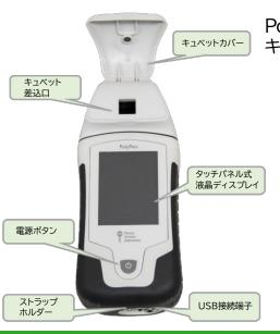
PolyPen-Aqua PA210は、懸濁液の分光測定を目的としたキセノン白熱ランプ、GPS内蔵の携帯型測定器です。
