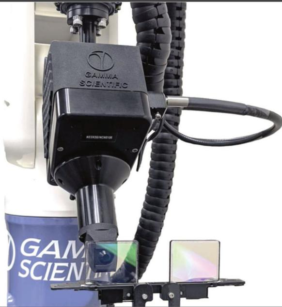
目が本当に見ているものを測る。Gamma Scientificは、世界で初めて高解像度・広視野角の分光放射輝度計と画質解析ソリューションを提供し、拡張現実(AR)、バーチャルリアリティ(VR)、複合現実(MR)、ヘッドアップディスプレイ(HUD)の仮想イメージと適格な視聴空間を高精度に評価します。
