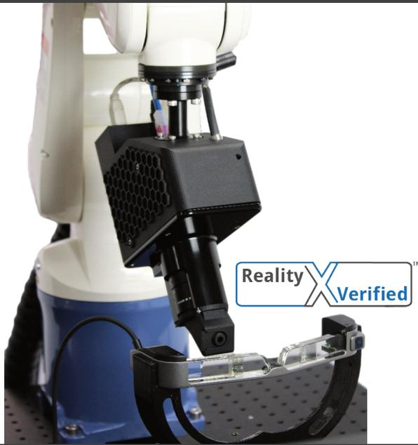
目が本当に見ているものを測る。Gamma Scientificは、世界で初めて高解像度・広視野角の分光放射輝度計と画質解析ソリューションを提供し、拡張現実(AR)、バーチャルリアリティ(VR)、複合現実(MR)、ヘッドアップディスプレイ(HUD)の仮想イメージと適格な視聴空間を高精度に評価します。
