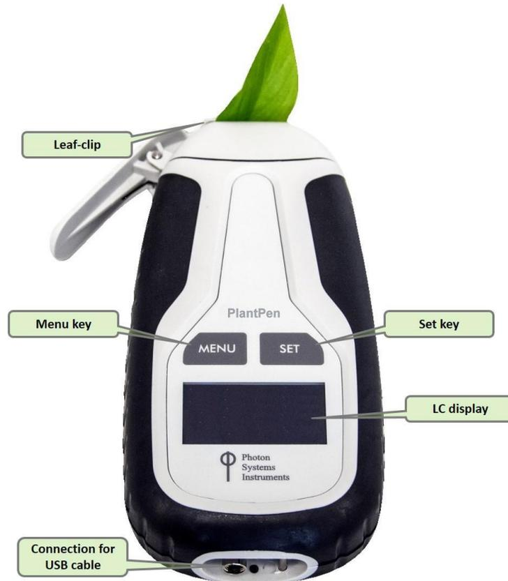
PlantPen NDVI 310は、野外で簡単にNDVIを測定できる携帯型測定器です。
